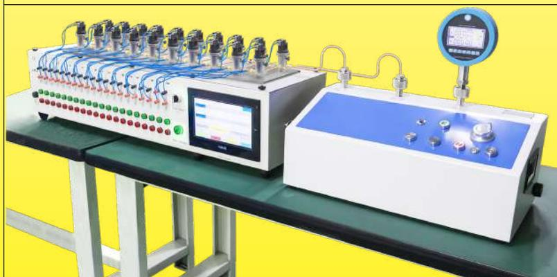
Vérification de l'étalonnage des pressostats
